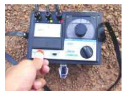
ตรวจสอบค่าความต้านทานสายดิน
